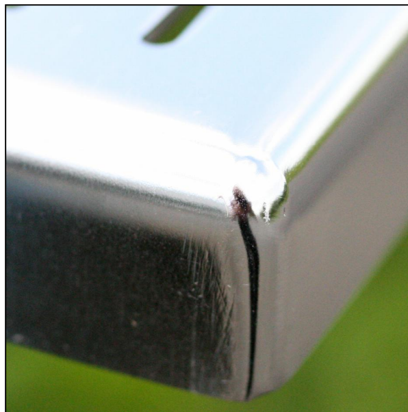
Bild: Lochblechkassette aus WN 1.4301 2B, nachträglich elektropoliert auf Korrosionsschutzgründen:
